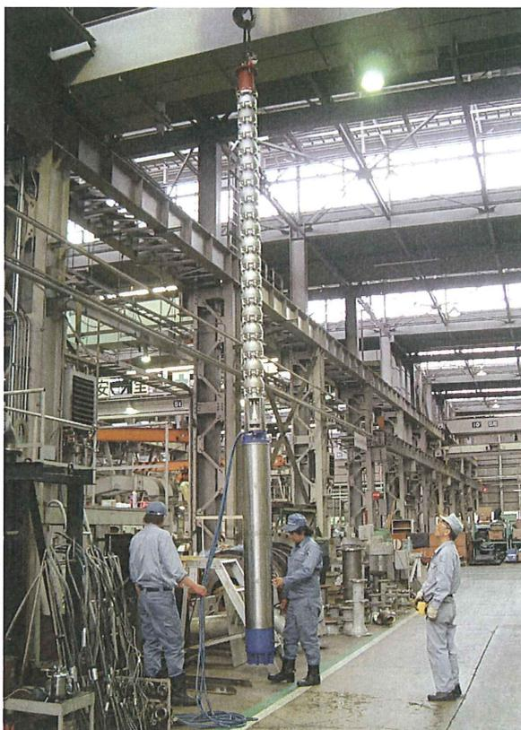
型式 OPDS12J-150-400-17 材質 SCS13 SUS304 設置 横置き フロースリーブ付き
