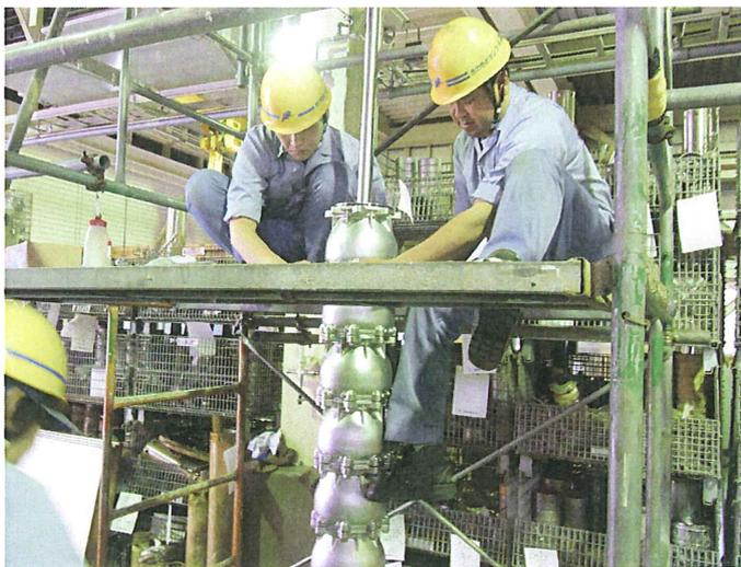
試験は400kW、50Hz、1000Vの日本ではきわめて特殊なものだったが、事前にPre-Testで性能確認を行った事により、羽根車調整等を行う事なく仕様点をクリアできた。
