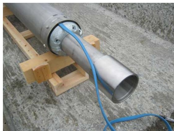
設置台数は2台で通常は単独交互運転。メンテナンス用として当社独自のバイパス管を利用した逆洗機能により水中ポンプ及び吸込み部に付着した藻や貝類の洗浄ができる付加機能を持っています。
